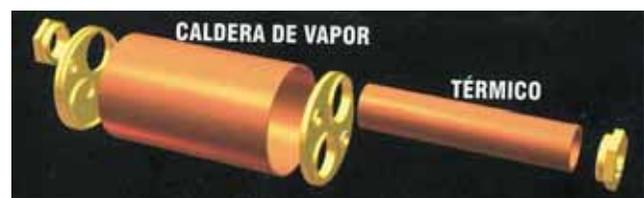
CALDERA DE COBRE DE 1.8 LITROS. DOTADA DE CÁMARA DE VAPOR CONTINUO: CAPAZ DE CALENTAR CUATRO VASOS DE LECHE EN 60". LA CALDERA ES ATRAVESADA POR EL TÉRMICO REPLETO DE AGUA A 100° MANTENIENDO EL GRUPO EROGADOR DE CAFÉ EN LA TEMPERATURA ÓPTIMA PARA HACER LA MEJOR INFUSIÓN DEL EXPRESSO.
