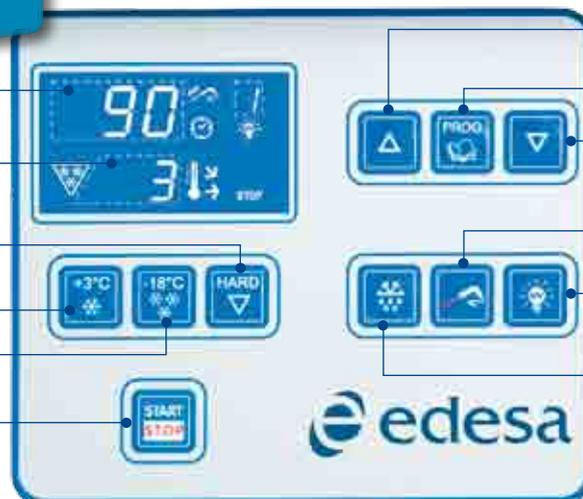
Incremento de valores, visualiza la temperatura de la aguja sonda.
