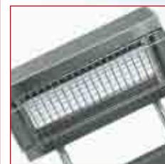
**Conservador de fritos eléctrico**. Calentamiento mediante resistencia superior de cerámica e inferior de acero inoxidable. Con **cubeta GN 1/1 de 150 mm** de profundidad y fondo perforado extraíble para escurrir el aceite.
